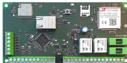
La centrale IT4 viene offerta in due versioni in funzione del contenitore e della capacità della batteria alloggiabile. Per alimentare la centrale e gli altri componenti del sistema di allarme nel contenitore si trova anche un alimentatore caricabatteria da 2 A ad alta efficienza.
