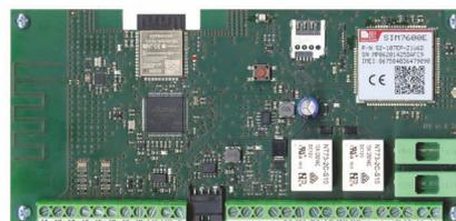
La centrale IT1 si presenta con un contenitore compatto, particolarmente curato nell'estetica e molto funzionale. All'interno si trova la scheda di controllo, un alimentatore caricabatteria da 2 A ad alta efficienza, una sirena e le antenne necessarie per le comunicazioni radio. Le dimensioni di cm 22 x 30 x 7,5 permettono di contenere batterie a 12 Volt da 2,3 Ah o da 7 Ah. Necessita di sim-card per le funzioni di telefonia mobile.
