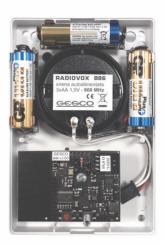
La temperatura dell'ambiente viene misurata ogni minuto e il valore viene trasmesso ogni volta che avviene una variazione. Il sensore funziona da -10°C a + 50°C e la precisione migliore è garantita tra 10°C e 30°C.
